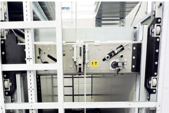
升降機構通過鋼蕊齒型皮帶傳動，兩側共16個定位輪
